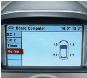
Das Reifendruck-Kontrollsystem (RDKS) oder Tire Pressure Monitoring System (TPMS) dient der Überwachung des Reifendrucks, um fehlerhafte Reifen frühzeitig zu erkennen und so mögliche Unfälle zu verhindern. Ferner lässt sich mit dem optimalen Reifendruck Kraftstoff sparen und unnötiger Reifenverschleiß vermeiden.
